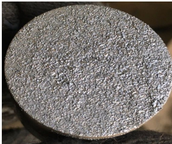
Рис. 2. Покриття, нанесене на матрицю і штифт методом дугової металізації з пульсуючим розпилювальним струменем.
