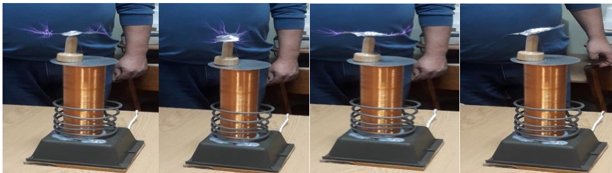
Рис. 8 «Спрінклер Фейнмана» (іонний вітер)
