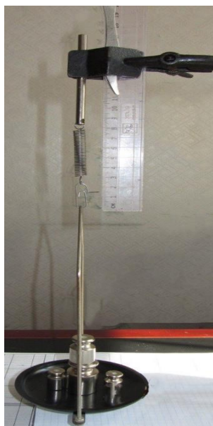
Рис. 2. Тарування пружини динамометра приладу Ф24-1
