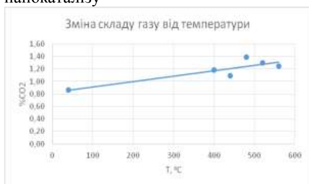
Рис.4 Графік зміни кількісного складу продукту реакції від температури при пустотілому реакторі
