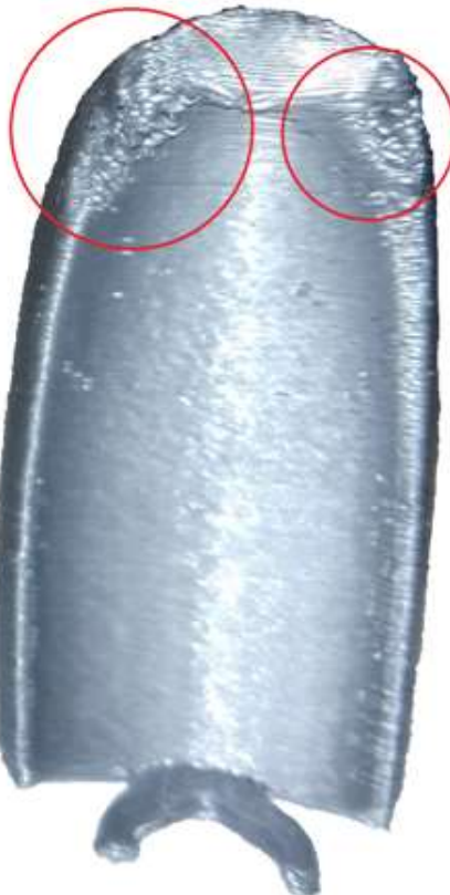
Рис. 2. Загальний вигляд надрукованої деталі з оплавленими гранями
